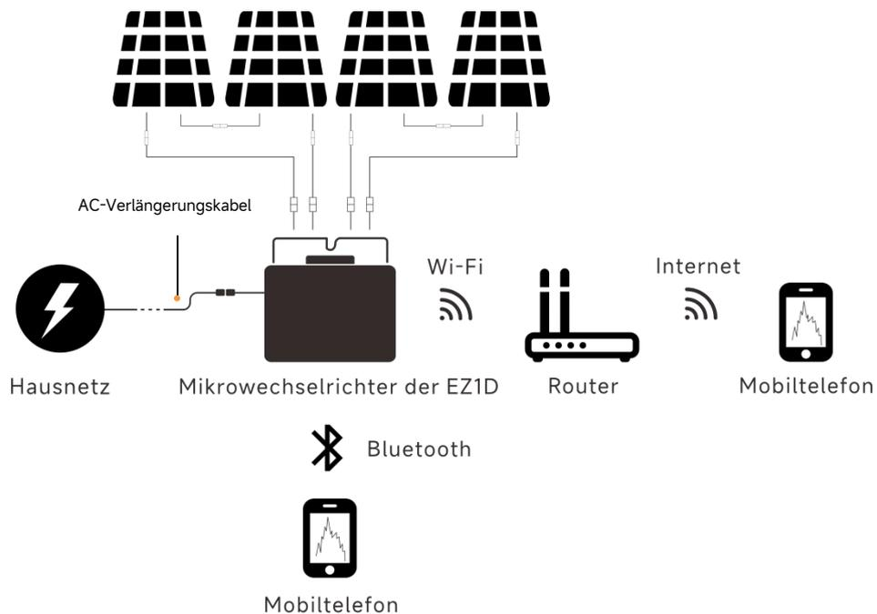
Die EZ1D-Serie ist die speziell für DIY-Anwendungen entwickelte Wi-Fi-Version der 3. Generation der Dual-Mikrowechselrichter von APsystems. Die EZ1D-Serie verfügt über 2 Eingangskanäle mit unabhängigen MPPTs bzw. mit hoher Eingangsstromstärke und Ausgangsleistung, um den heutigen Hochleistungsmodulen gerecht zu werden.
