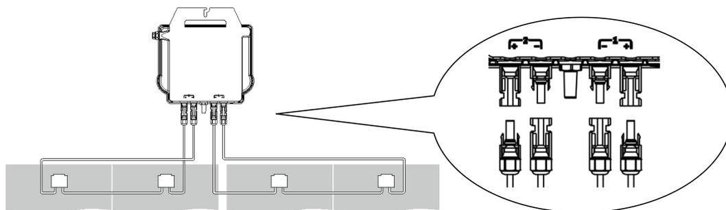
Beim Anschließen der DC-Kabel sollte der Mikrowechselrichter sofort zehnmal grün blinken. Dies geschieht, sobald die Gleichstromkabel angeschlossen sind, und zeigt an, dass der Mikrowechselrichter korrekt funktioniert. Diese gesamte Prüffunktion beginnt und endet innerhalb von 10 Sekunden nach dem Anschließen des Geräts, achten Sie also beim Anschließen der Gleichstromkabel auf diese Lichtsignale.
