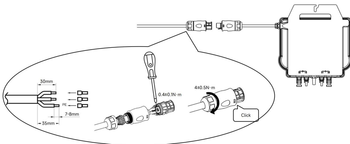
Schließen die Betteri-Buchse am Ende des AC-Kabels an.
