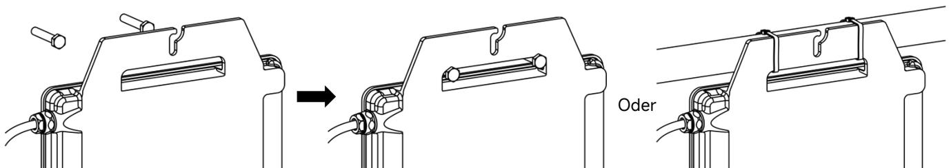
Installieren Sie die Mikrowechselrichter an einer geeigneten Position, um zu verhindern, dass sie direktem Regen, UV-Strahlung oder anderen schädlichen Witterungseinflüssen ausgesetzt sind.
