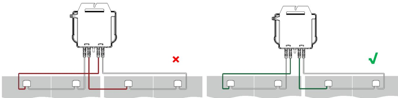
1. Jedes PV-Panel muss sorgfältig an denselben Kanal angeschlossen werden.
