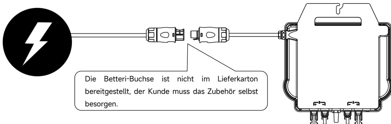
Schließen Sie den AC-Stecker des Mikrowechselrichters mit der Betteri-Buchse\* an, danach verbinden Sie den Mikrowechselrichter mit dem Hausnetz.
